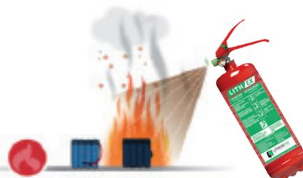
3 La combustione degli idrocarburi è responsabile della propagazione dell'incendio alle altre celle (reazione a catena).
