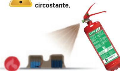
5 Lo strato di vermiculite, solidificando, incapsula le celle della batteria separando il principio di incendio dall'ossigeno contenuto nell'area circostante.
