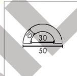
**2 PGE435S** - paracolpi lunghezza 780 mm x altezza 30 mm, peso 135 gr con biadesivo
