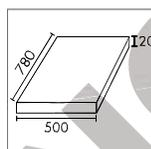
**5 PGE902S** - paracolpi piano rigato mm 780 x 500 x h 20 colore giallo/nero, spessore 20 mm, peso kg 1,9, senza biadesivo
