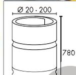
**4 PGE801S** - paracolpi cavo rigato giallo/nero, senza biadesivo. Protegge colonne tonde, pali e corrimano, utilizzato anche come salva colonne in parcheggi e garage. Ø minimo 20 mm, Ø max 200 mm. Altezza 780 mm, spessore 20 mm, peso kg 1,2
