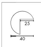
**1 PGE425S** - paracolpi lunghezza 780 mm x Ø 40 mm, peso 135 gr con biadesivo
